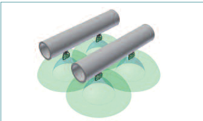
Figura 8. Distribuição dos bicos aspersores de água nos resfriadores SLI, SRA e SLMI e condensadores SLC, SLMC e SCA
